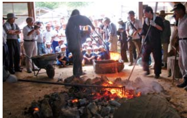
壊した炉の土ぼこりが舞う中、鉄の塊「ケラ」が取り出されました
