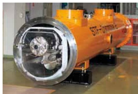
加速器の心臓部であるクライオモジュール
