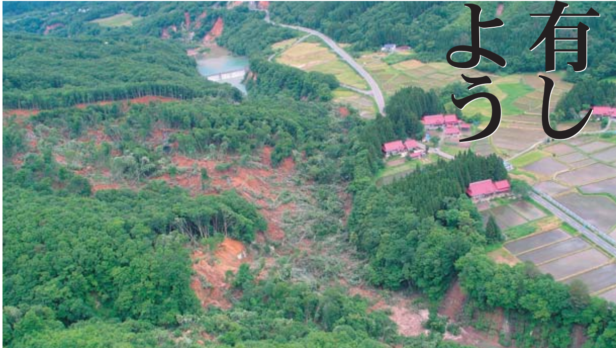
▼大規模な地すべりが磐井川をせき止めてできた土砂ダム(20年6月14日撮影)。現在は仮排水路が開通し、さらに本復旧に向けて河道の拡幅が進められています
