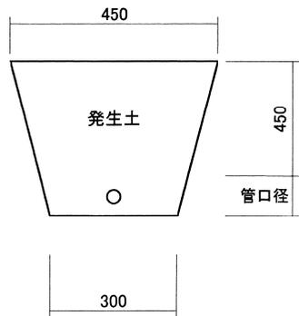
給水管掘削標準断面図
