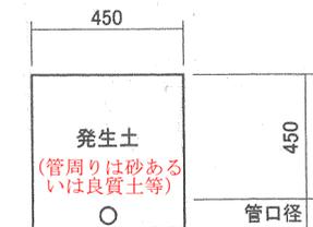
給水管掘削標準断面図
