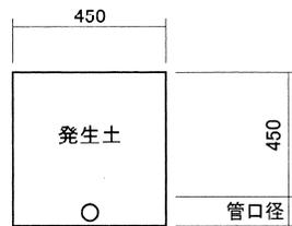
図5-4 給水管掘削標準断面図
