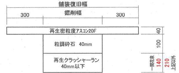
図5-4 給水管掘削標準断面図
