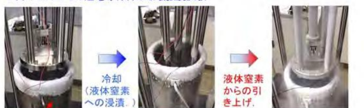
冷却完了。曲げ試験中。
