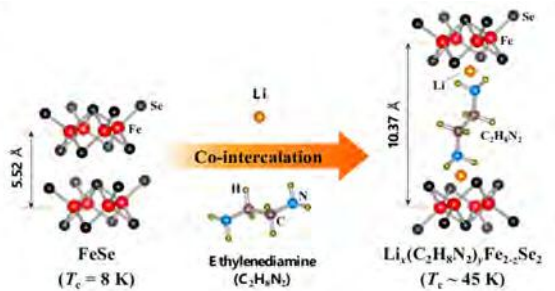
Fig. FeSeへのLiとEthylenediamineのコインターカレーション(共挿入)。
