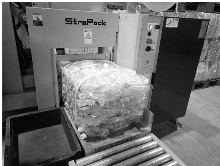
図 3-5-1 ボールの姿図（ペットボトルボール品、PP バンド結束中）
