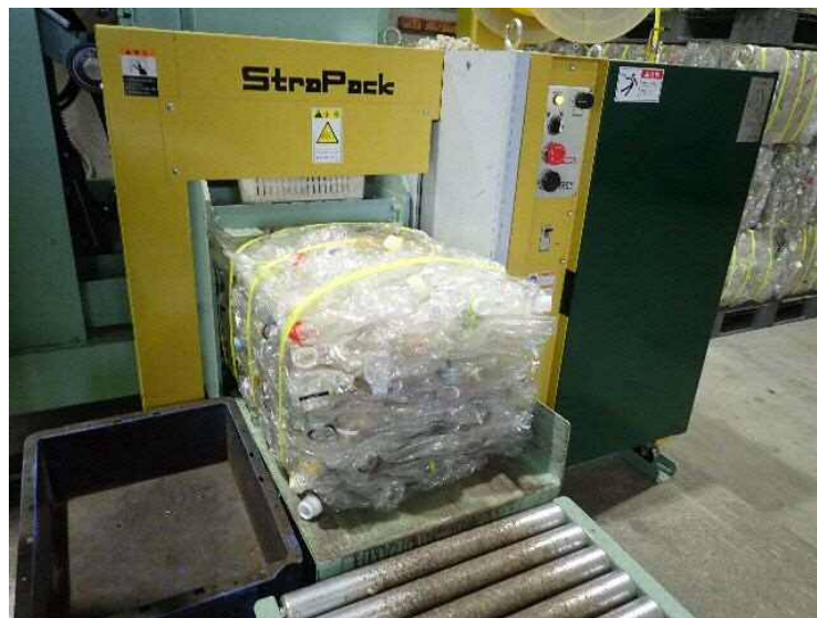
図 3-5-1 ベールの姿図（ペットボトルベール品、PP バンド結束中）
