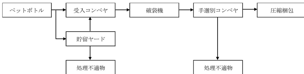
図 5-4 ペットボトル処理基本フロー（参考図）
