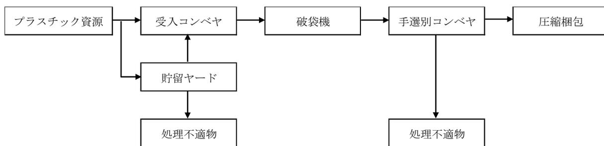
図 5-5 プラスチック資源処理基本フロー（参考図）
