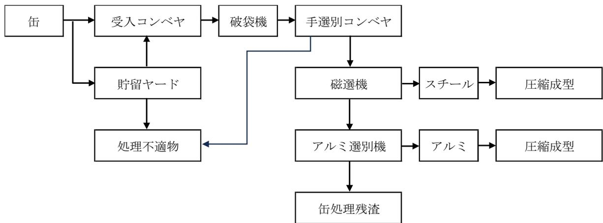
図 5-3 缶処理基本フロー（参考図）
