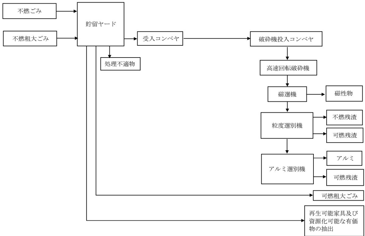
図 5-2 不燃ごみ・不燃粗大ごみ処理基本フロー（参考図）
