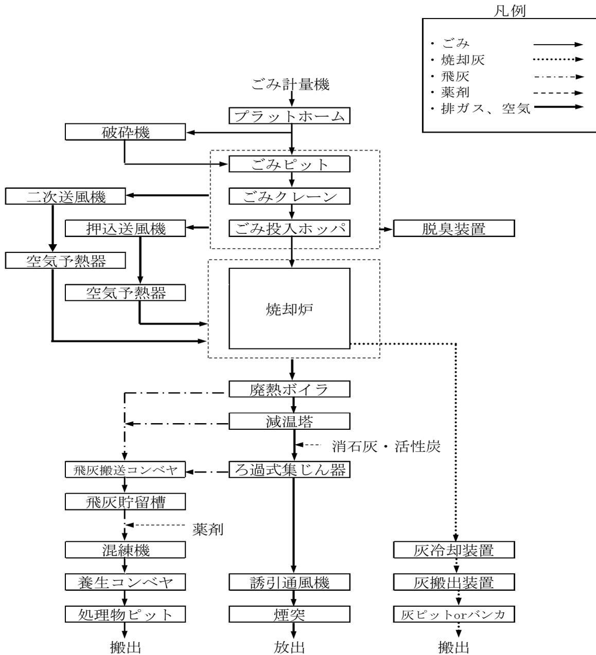
図 5-1 可燃ごみ処理基本フロー (参考図)
