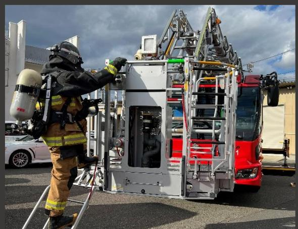
①最高で地上 35m、ビルの 12 階相当まで到達が可能です。さらに、はしご先端が屈折(約 2.5m、最大 80 度)し、電線や樹木などの障害物を避けて建物に接近することが可能。
