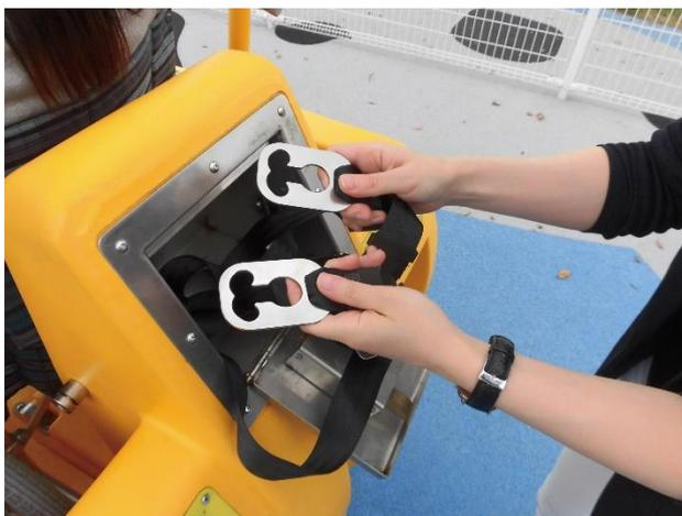
3. シートベルトは、カプセルの後ろ側に設置された収納箱に入っています。(鍵を回しながら手前に引く)
