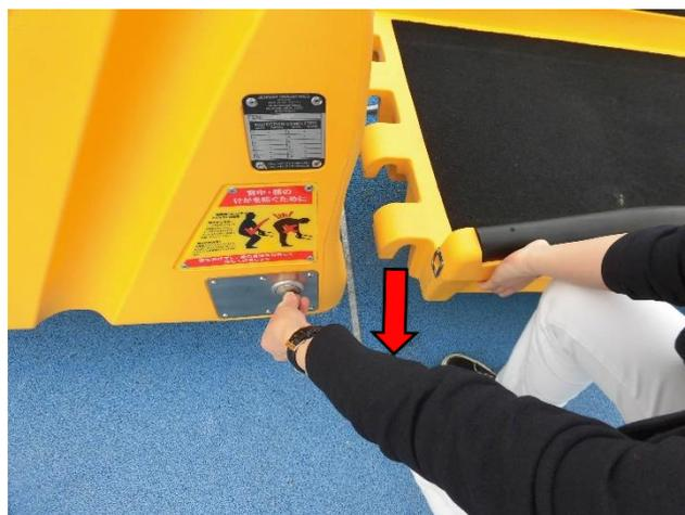
4. ノブを回して乗降機（オン／オフデバイス）のロックを解除し、持ち上げてブランコを解放します。
