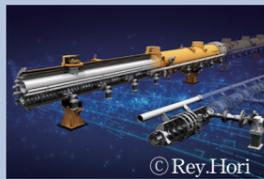
超伝導加速空洞をマイナス271度まで冷やす魔法瓶のような装置。中を電子・陽電子のビームがほぼ光の速さで駆け抜けていく。
