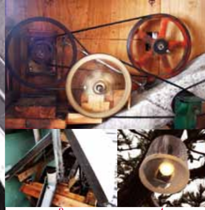
2) 水の位置エネルギーを受け、幅2メートルの水車が回転する／2) 水車が回転すると室内にある大小8つの滑車も連動する／3) 高さ3.5メートルから水が落水／4) 水力発電により点灯する外灯
