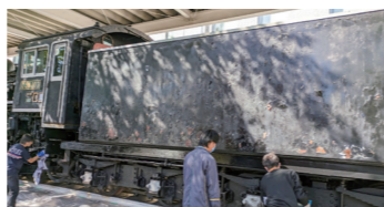
劣化が進み、全面塗装が急がれるSL
